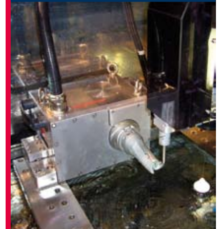
Rostfreie Rundteiltische und A-Achsen für Draht- und Senkerodiermaschinen
