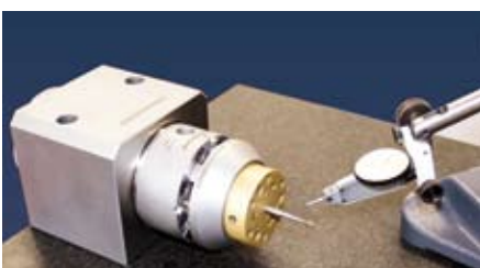
Voreinstellung mit Voreinstellspindel und Justier-Spannelement
