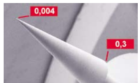
Edelstahlnadel für die Medizintechnik Ra 0,2 - 0,25 µm
