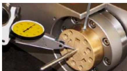
Rundlauf-Einstellung mit Justier-Spannelement H 5.83.46R..
